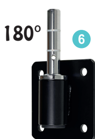
Für die Wandmontage. Drei verschiedene Winkel. Lieferung ohne Verbindungselemente. Geeignet für M8-Schrauben (4 x Ø10mm Montageloch) von Mitte zu Mitte Loch: 70mm
