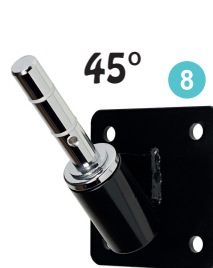
Für die Wandmontage. Drei verschiedene Winkel. Lieferung ohne Verbindungselemente. Geeignet für M8-Schrauben (4 x Ø10mm Montageloch) von Mitte zu Mitte Loch: 70mm
