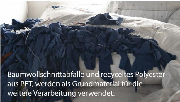
Baumwollschnittabfälle und recyceltes Polyester aus PET, werden als Grundmaterial für die weitere Verarbeitung verwendet.
